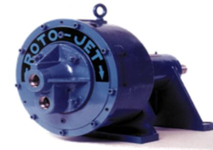
**ROTOJET PUMPS (Grupo Trillium Flow Technologies)** Bombas centrífugas de tubo pitot que permiten manejar alta presión y caudal medio/alto. Capacidades de hasta 170m<sup>3</sup>/h y una altura de 1676m, para temperaturas de 0°C a 288°C.
